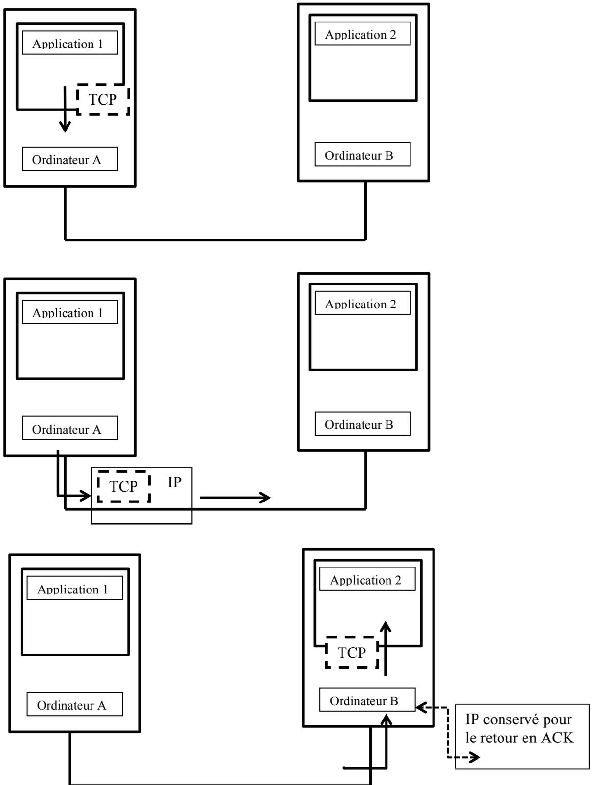
Le retour pour confirmation (acknowledgment) se fait suivant le même principe.
